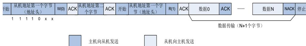
图 19-8. 10 位地址的 I2C 通讯流程（主机接收，HEAD10R=1）
