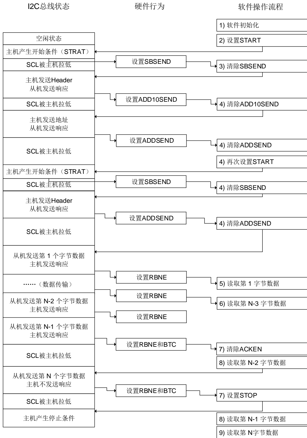
图 20-13. 主机接收使用方案 B 模式（10 位地址模式）
