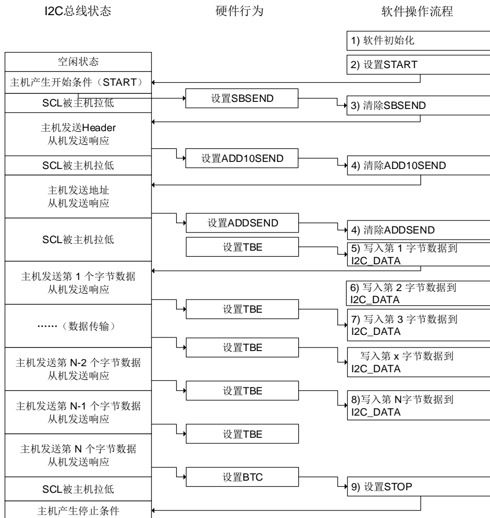
图 20-11. 主机发送模式 (10 位地址模式)
